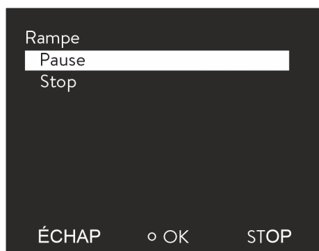
Fig. 64 : Interrompre ou arrêter une rampe
